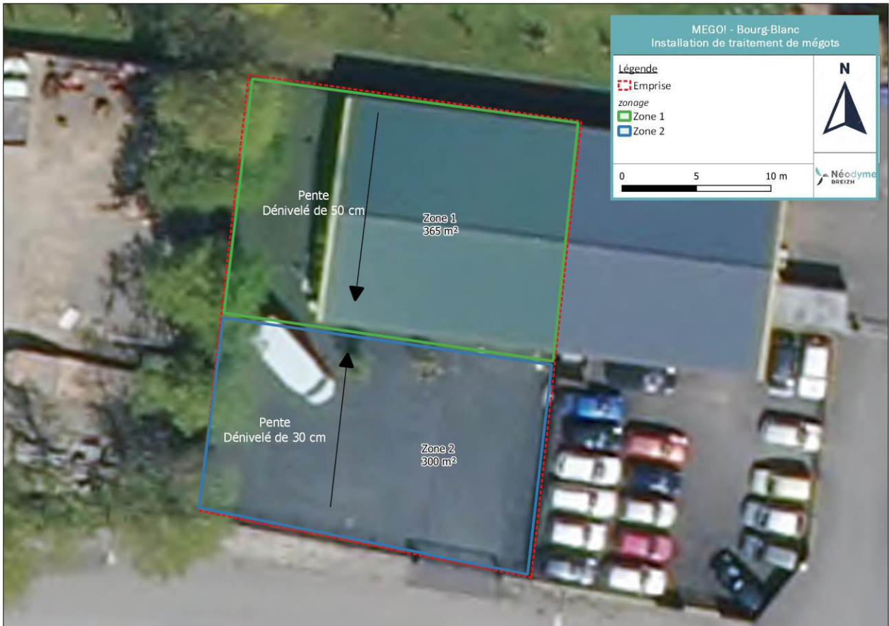
Illustration 4 : Caractérisation des volumes de confinement des eaux d'extinction incendie
